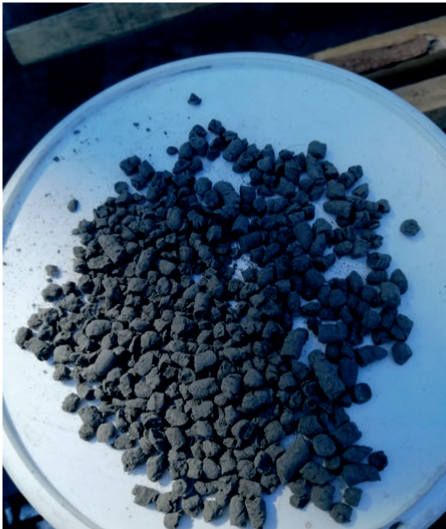
Fot. 1. Granulat wytworzony z pyłu bazaltowego i siarki Photo 1. Granules produced from basalt dust and sulfur
