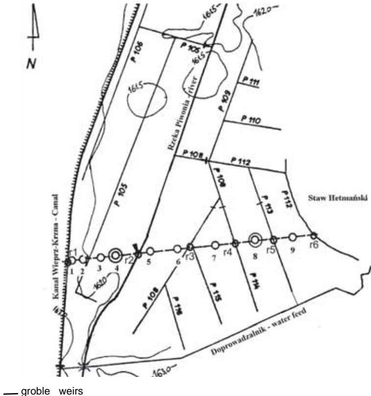
Rys. 1. Lokalizacja punktów badań w przekroju hydrometrycznym; 1–9 – punkty badawcze; źródło: opracowanie własne
