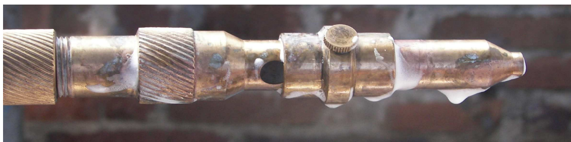
Fot. 1 Fragment prądownicy z przysłoniętym otworem odprowadzającym nadmiar piany
