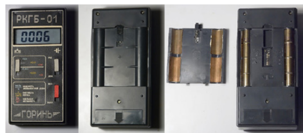
Fot. 15. Dozometr-radiometr RKGB-01 Gorin' – z prawej ze zdjętym filtrem, widoczne mikroprzełączniki na spodnim panelu Photo 15. Dosimeter-radiometer RKGB-01 Gorin – on the right with removed filter, visible microswitches on bottom side
