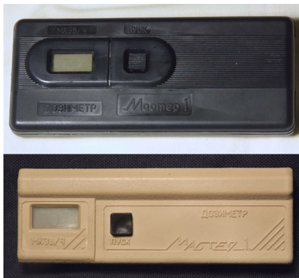
Fot. 6. Dwie wersje obudowy dozymetru Master-1. Mniejsza wersja w rzadkim, kremowym kolorze
