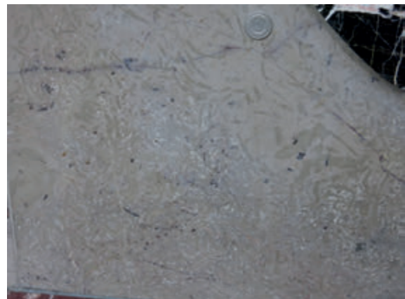
Fot. 3. Typy wapieni w złożu Szewce: A - wapień amfiporowy ( floatstone ), o spoiwie mikrytowym/mikrosparytowym, typowy dla złoża Szewce; B - fragment gałązkowej kolonii amfipor „uszczelnionej” mikrytem ( bafflestone ), obecne żyłki kalcytowe o fioletowym zabarwieniu oraz stylolity; C - kontakt bafflestonu i floatstonu wewnątrz ławicy wapienia amfiporowego, przy lewej krawędzi zdjęcia obecna kolonia stromatolityczna
