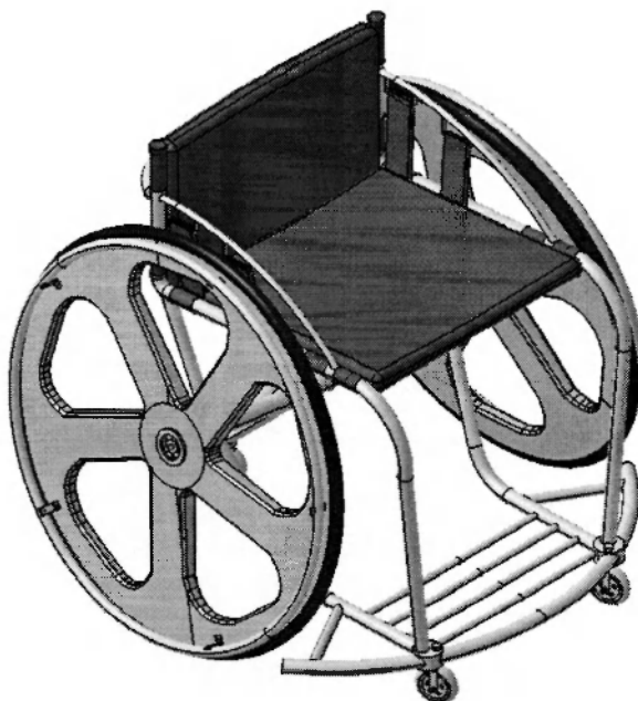
Rys. 5. Wirtualny model wózka inwalidzkiego sportowego – widok izometryczny
