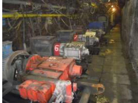
Rys. 12.16 Pompa oraz schemat pompy nurnikowej do tłoczenia emulsji olejowo-wodnej stosowanej w pompowniach centralnej stacji pomp wysokociśnieniowych
