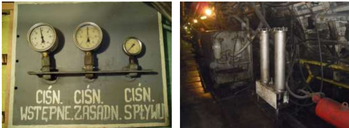
Rys. 12.18 Tablice z urządzeniami pomiarowymi, znajdującymi się w kabinie dźwiękoszczelnej oraz zestawy filtrów na spływie emulsji
