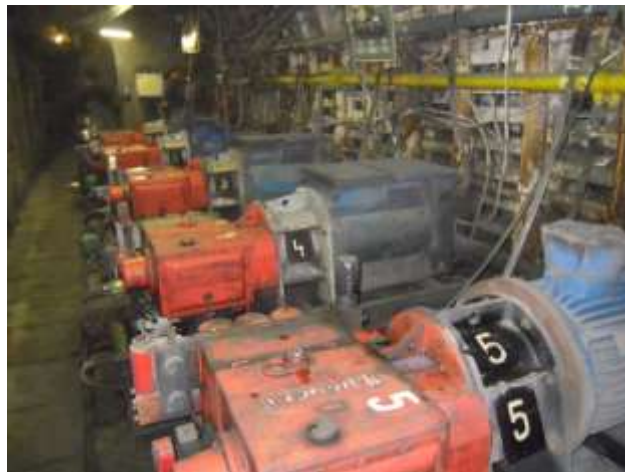
Rys. 12.17 Pompa oraz schemat pompy nurnikowej do tłoczenia emulsji olejowo-wodnej stosowanej w pompowniach centralnej stacji pomp wysokociśnieniowych
