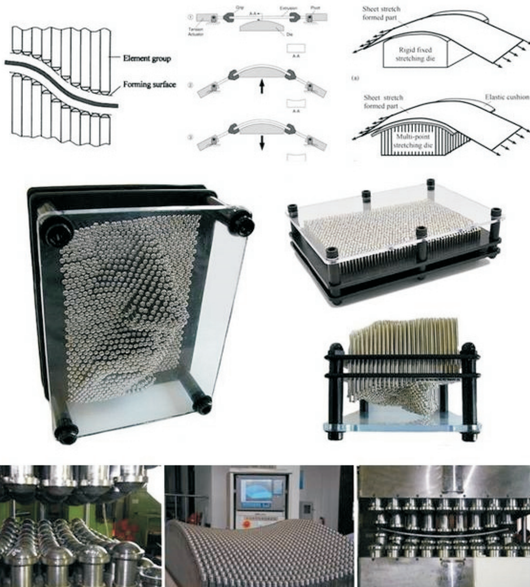
Ryc. 8. Reprogramowalna forma negatywowa o podwójnej i pojedynczej krzywiznie, na której odciskano panele dla DDP; źródło: dzięki uprzejmości Zaha Hadid Architects/source: courtesy Zaha Hadid Architects
