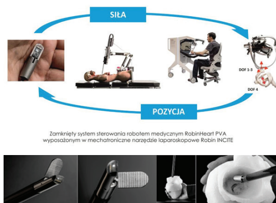
Rysunek 4. Idea siłowego sprzężenia zwrotnego Robin Heart INCITE. Innowacyjne sensory i ich zastosowanie w narzędziu robota Robin Heart
