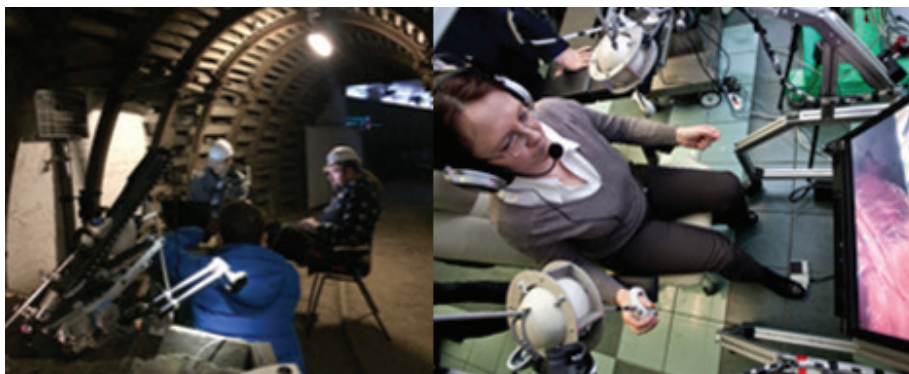
Rysunek 2. RobinHeart Team (FRK) wykonał pionierskie w Polsce badania w zakresie teleoperacji. Na zdjęciu po lewej eksperyment zdalnego sterowania robotem Robin Heart Pelikan w Kopalni Guido w Zabrze (poziom – 320 m), po prawej: model teleoperacji Zabrze-Katowice, z FRK do Centrum Medycyny Doświadczalnej Śląskiego Uniwersytetu Medycznego w Katowicach
