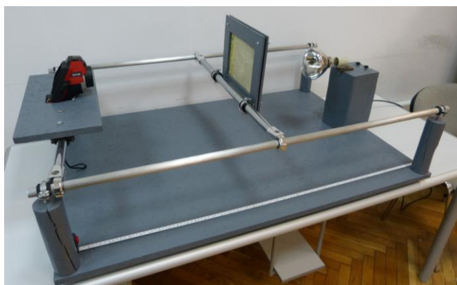
Rys. 1. Stanowisko do badań termograficznych
