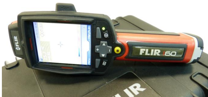
Rys. 2. Kamera termowizyjna FLIR i60
