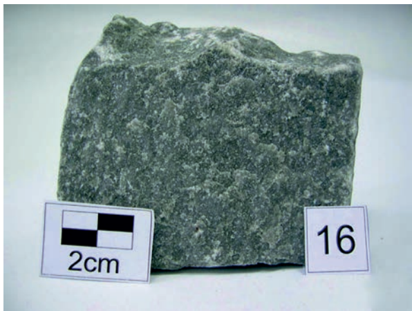
Rys. 3. Próbkę piaskowca anhydrytowego [4] Fig. 3. Sample of the anhydritic sandstone [4]
