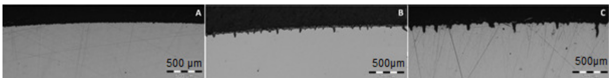
Rys. 6. Widok pęknięć zmęczeniowych na przekroju próbek walcowych po 600 cyklach: A – T_g = 650^\circ\text{C} , B – T_g = 700^\circ\text{C} , C – T_g = 750^\circ\text{C}
