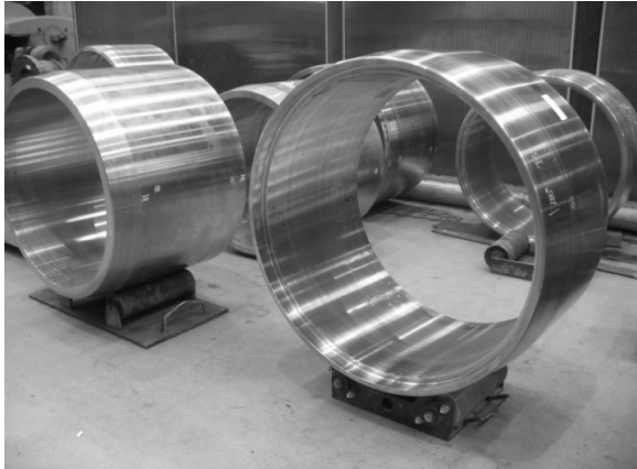
Rys. 5. Kołpaki wirników generatorów (paramagnetyk)
