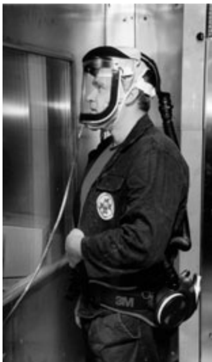
Fot. 4. Badania sprzętu z wymuszonym przepływem powietrza
