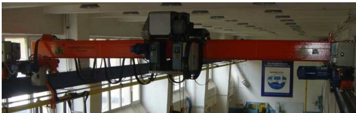
Rys. 1. Lekka suwnica pomostowa natorowa w Laboratorium Zakładu Inżynierii Maszyn Roboczych i Pojazdów Przemysłowych Politechniki Wrocławskiej Źródło: [materiały własne]
