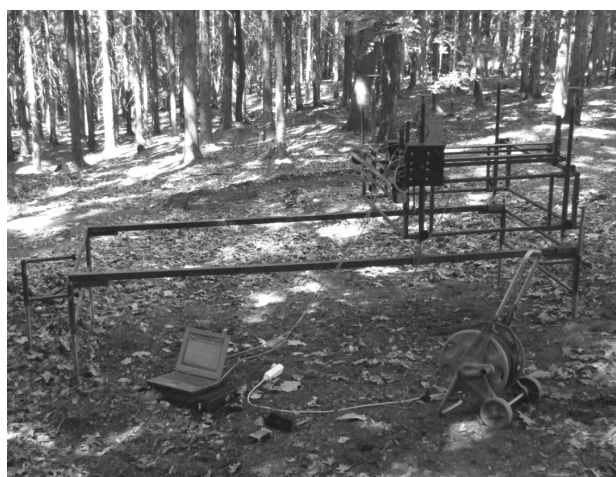
Rysunek 2. Fotografia komputerowego urządzenia do bezkontaktowego odwzorowania powierzchni terenu, w trakcie wykonywania odwzorowania leśnego szlaku zrywkowego Figure 2. A computer photography of the device for remote imaging of land surface during imaging of the forest skidding road
