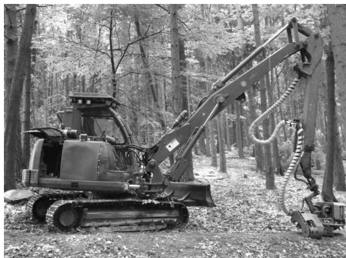
Rysunek 1. Harwester Mht 8002 HV z głowicą harwesterową LOGMAX 928
