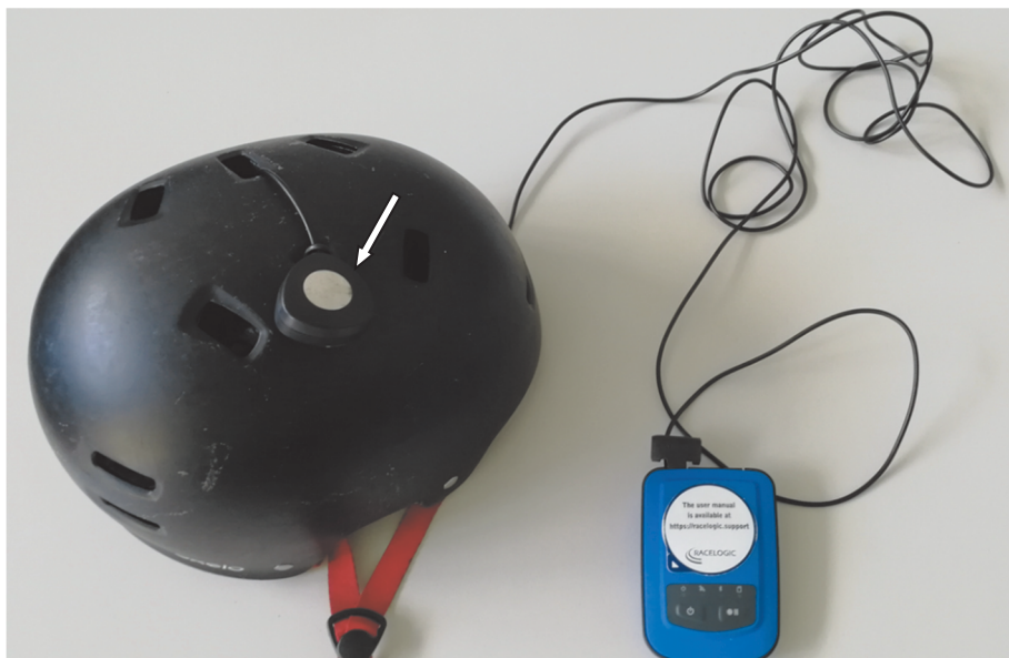
Ryc. 5. Urządzenie pomiarowe VBox Sport z anteną GPS, zamontowaną na kasku ochronnym.
