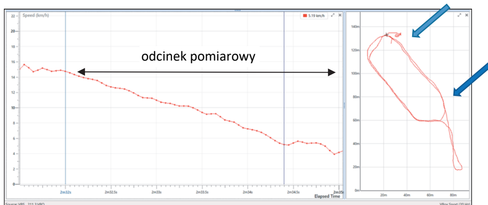
Ryc. 8. Przykład analizy wykresu w celu określenia wartości opóźnienia hamowania.
