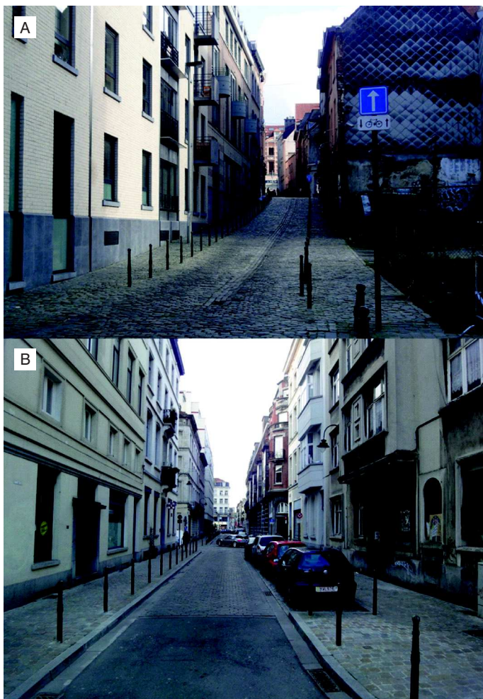
Fot. 4. Przykłady stosowania słupków: A) eliminacja nieprzepisowego parkowania, B) wymuszenia prawidłowego sposobu parkowania
