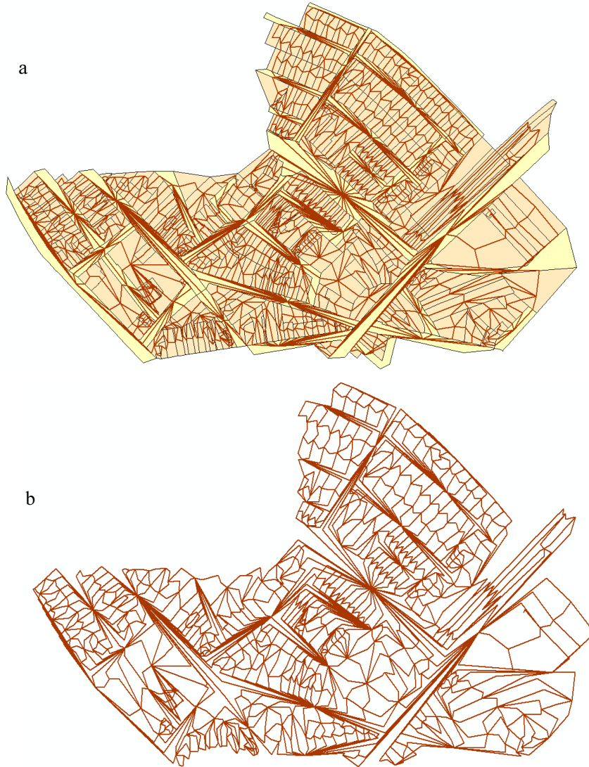
Rys. 6. Model ( C-K-C ) sąsiedztwa parcel uzyskany z danych topologicznych i geometrycznych w oparciu o sąsiedztwo linii granicznych i działek: a – sieć powiązań centroidów działek i linii granicznych, przedstawiona na tle mapy ewidencyjnej, b – przedstawienie samej sieci, w celu lepszej widoczności struktury
