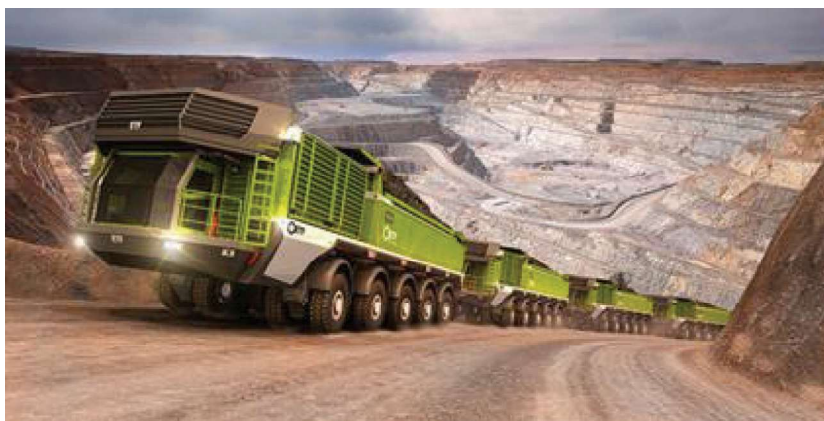
Rys. 7. Pociąg oponowy firmy ETF MINING EQUIPMENT Fig. 7. Haul train ETF MINING EQUIPMENT
