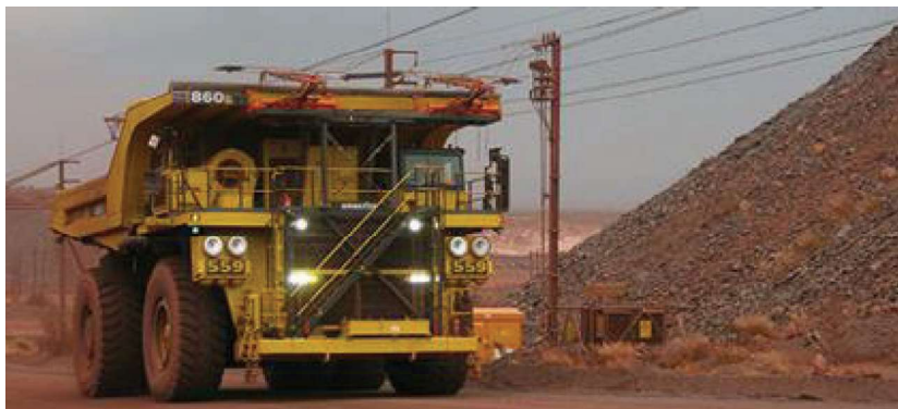
Rys. 6. Wóz odstawczy zasilany energią elektryczną z układu pantografów Fig. 6. A dump truck powered by electricity from the pantograph system
