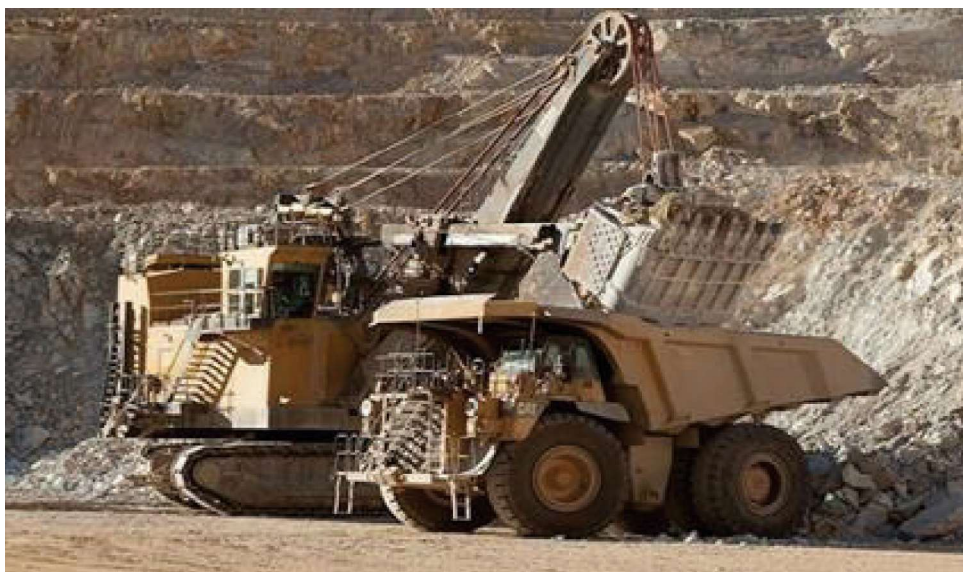
Rys. 4. Załadunek wozidła sztywnoramowego przez koparkę linową
