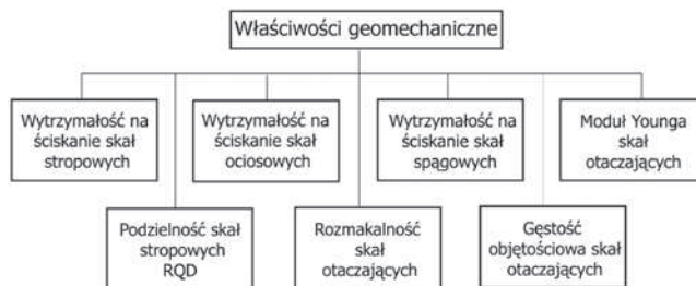
Rys. 1. Właściwości geomechaniczne skał wpływające na deformacje wyrobisk korytarzowych [12]
