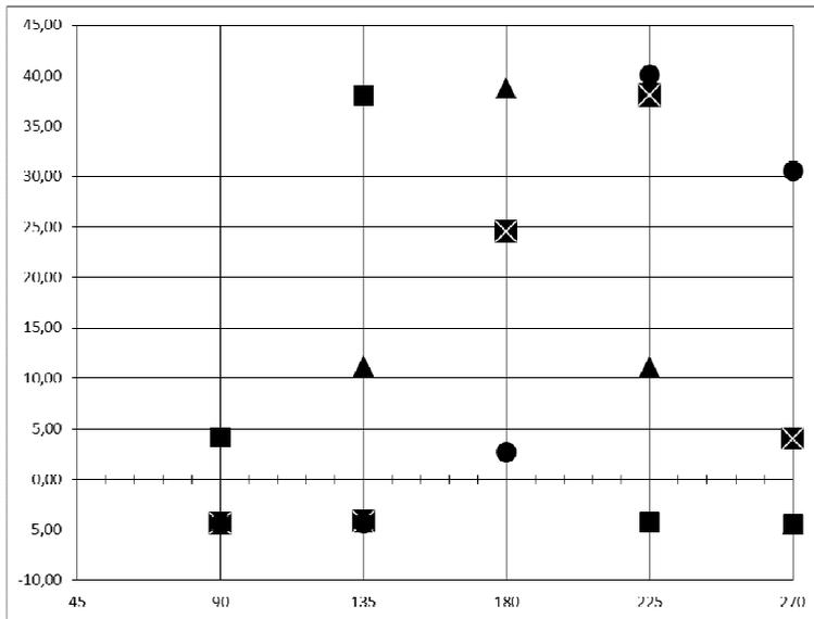
Рис. 7. Значения КПД в зависимости от ориентации абсорбера по отношению к северному направлению - март, температура внешнего воздуха минус 10°C. Обозначения см. рис. 3
