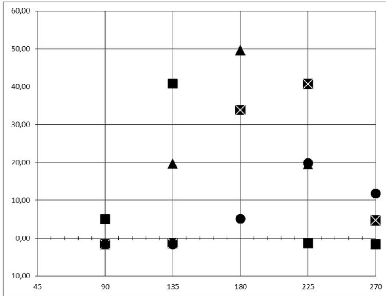
Рис. 6. Значения КПД в зависимости от ориентации абсорбера по отношению к северному направлению - декабрь, температура внешнего воздуха плюс 10°C. Обозначения см. рис. 3
