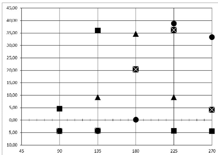
Рис. 3. Значения КПД в зависимости от ориентации абсорбера по отношению к северному направлению - октябрь, температура наружного воздуха минус 10°С: квадрат - 10 часов, треугольник 12 часов, квадрат с белым крестиком - 14 часов, круг - 16 часов
