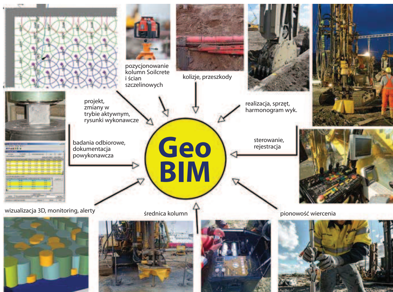
Rys. 3. Schemat uproszczonego modelu GeoBIM dla komory startowej TBM
