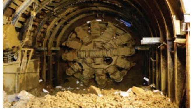
Ryc. 8. Czoło głowicy Robbins Open Gripper TBM zastosowanej przy wykonaniu tunelu [1]
