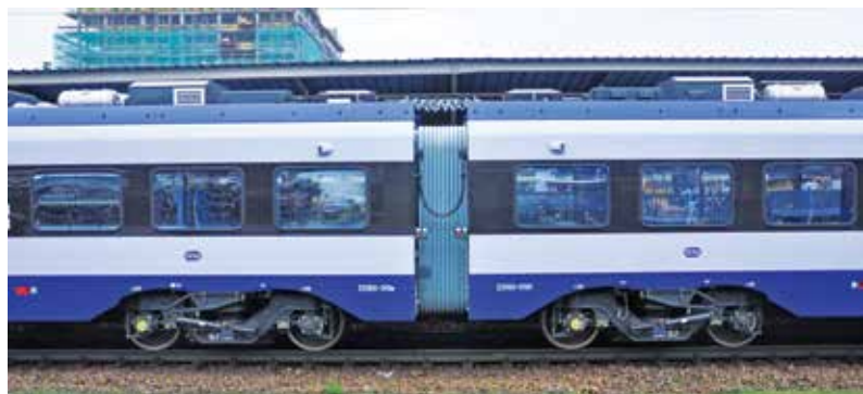
Połączenie międzywagonowe w zespole Flirt 3 . Fot. M. Graff
