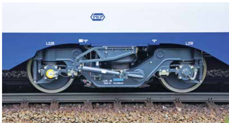
Wózek toczny w zespole Flirt 3 . Fot. M. Graff
