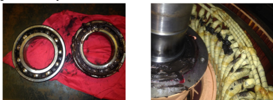
Rys. 6. Uszkodzone łożysko silnika oraz zanieczyszczone uzwojenia stojana
