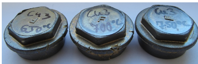
Rys. 6. Odkuwki z nowych stopów kształtowane przy różnych temperaturach; stopy: a) Cu-IMN-1, b) Cu-IMN-2, c) Cu-IMN-3
