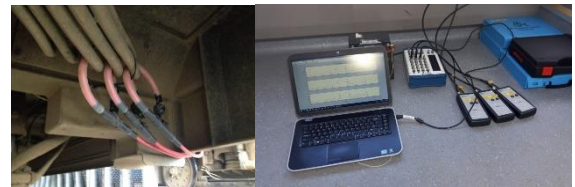
Rys. 14. Widok na komponenty systemu diagnostycznego podczas badań silników elektrycznych napędów wagonów tramwajowych
