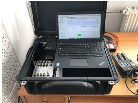
Rys. 5. Widok wnętrza walizki, w której zostały zabudowane elementy systemu
