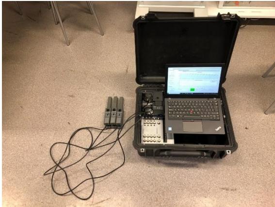
Rys. 6. Widok systemu pomiarowego przygotowanego do pracy – pomiar z użyciem cęgów prądowych
