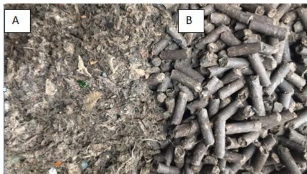
Rysunek 1. Materiał wsadowy (a) przed obróbką, (b) po obróbce wstępnej, źródło: materiały własne – Metal Expert Sp. z o.o. Sp. J.
