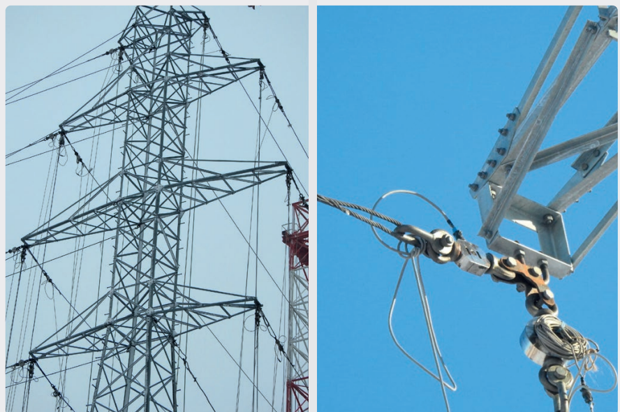
Fot. 1. Słup przygotowany do badań wytrzymałościowych wraz z układem lin i przewodów sygnałowych
