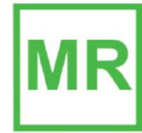
Rys. 4 Oznaczenie przedmiotów niepodlegających niepożądanym oddziaływaniom PMS, tzn. bezpiecznych w pobliżu MSRM – PN-EN-60601-2-33 Źródło: [18].
