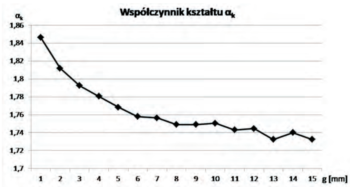
Rys. 5. Wyniki badań próbki z karbem 2U przy pomocy MES Fig. 5. Test results of a 2U notched sample using FEM
