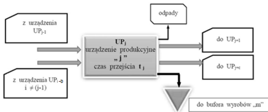
Rys. 2. Schemat przepływu materiału przez urządzenie produkcyjne UP
