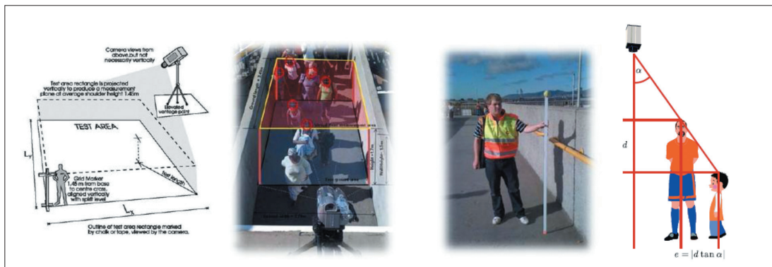
Rys. 2. Przykład zaawansowania kalibracji sprzętu potrzebnego do pomiarów ruchu pieszego Źródło: [5, 8]
