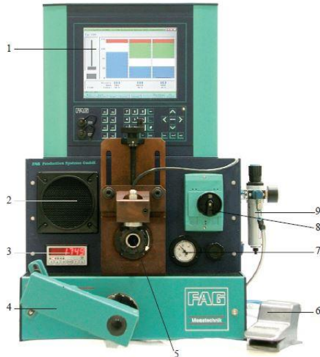
Rys. 1. Wibrometr MGG11 do badań drgań łożysk; 1 – komputer z oknem pomiarowym, 2 – głośnik, 3 – tachometr, 4 – pneumatyczny układ dociskowy, 5 – gniazdo mocujące trzpienia, 6 – pedał uruchamiający cykl pomiarowy, 7 – manometr, 8 – wyłącznik główny, 9 – reduktor ciśnienia powietrza z filtrem [7]
