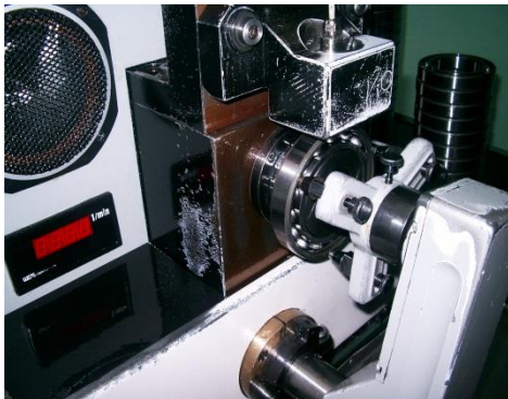
Rys. 2. Układ dociskowy wibrometru z badanym łożyskiem
