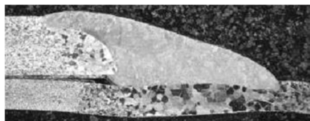
Rys. 11.6 Struktura łącza spawanego rury 2: a) powiększenie 10 x, b) powiększenie 50 x
