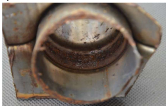
Rys. 11.9 Łącze spawane rury 2 po dziewięćdziesięciu cyklach testu korozyjnego
