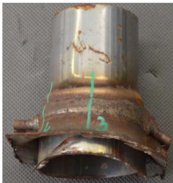
Rys. 11.8 Łącze spawane rury 1 po pięćdziesięciu cyklach testu korozyjnego
