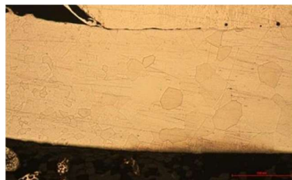
Rys. 11.6 Struktura łącza spawanego rury 2: a) powiększenie 10 x, b) powiększenie 50 x
