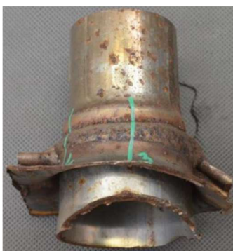
Rys. 11.9 Łącze spawane rury 2 po dziewięćdziesięciu cyklach testu korozyjnego
