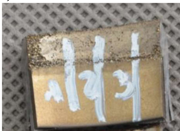
Rys. 11.10 Łącze spawane po teście odporności na korozję międzykrystaliczną: a) rura 1, b) rura 2.
