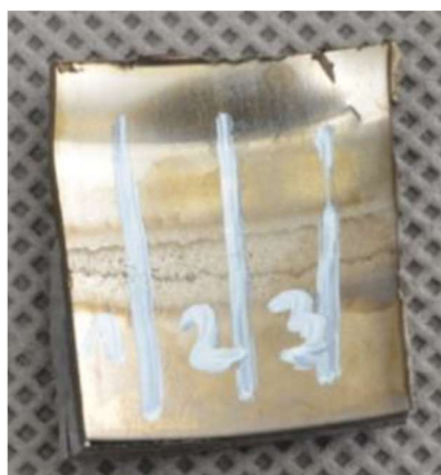
Rys. 11.10 Łącze spawane po teście odporności na korozję międzykrystaliczną: a) rura 1, b) rura 2.
