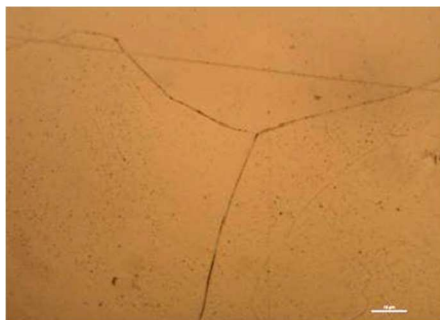
Rys. 11.7 Obraz granic ziaren w obrębie wpływu ciepła: a) rura 1, b) rura 2. Powiększenie 1000 x
