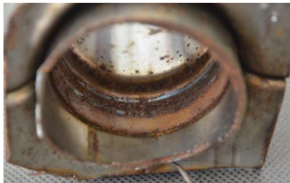
Rys. 11.8 Łącze spawane rury 1 po pięćdziesięciu cyklach testu korozyjnego
