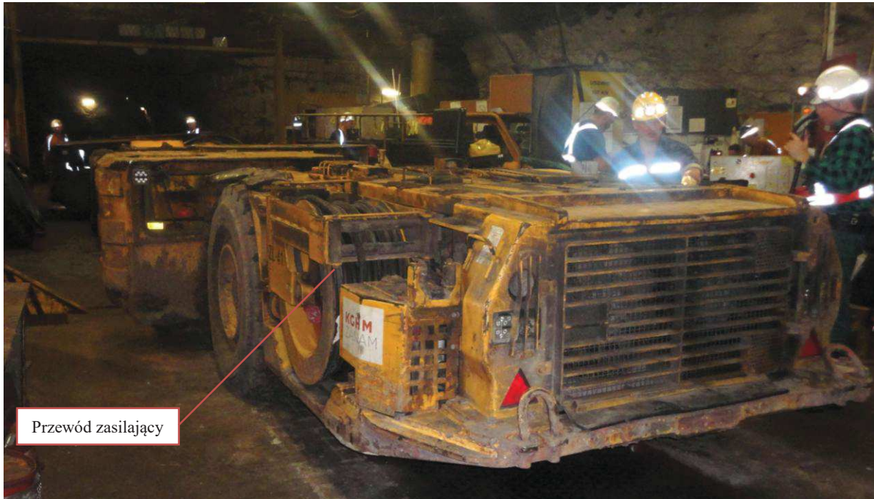
Rys. 1. Samojezdny wóz strzelniczy WS-151 produkcji KGHM-ZANAM [2]
