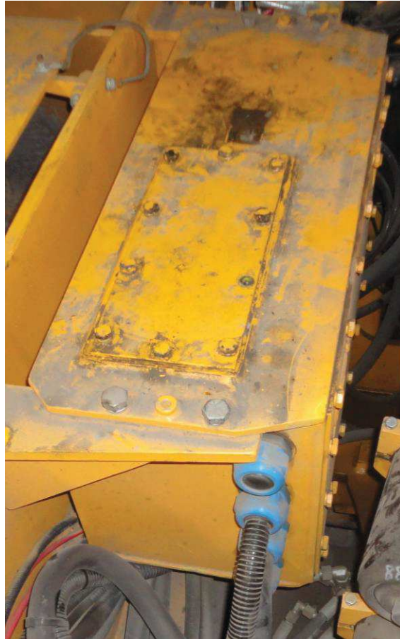
Rys. 3. Moduł aparatury zabudowany na wozie strzelniczym [2]
