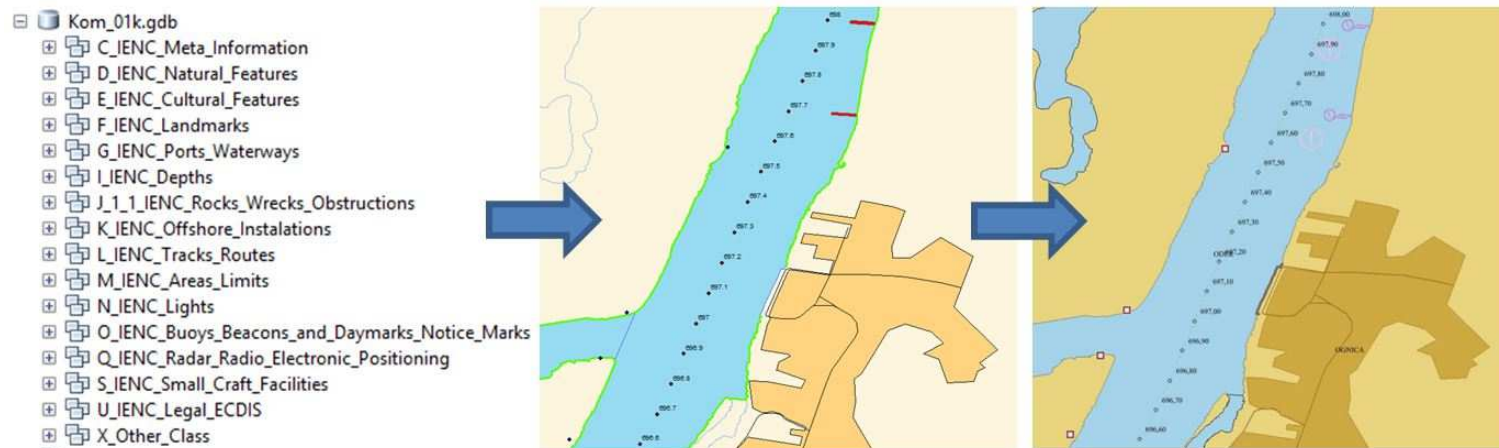
Rysunek 5. Opracowanie bazy danych GIS (ArcGIS), opracowanie danych dla mapy IENC (ArcGIS), opracowanie danych IENC w programie S-57 Composer
