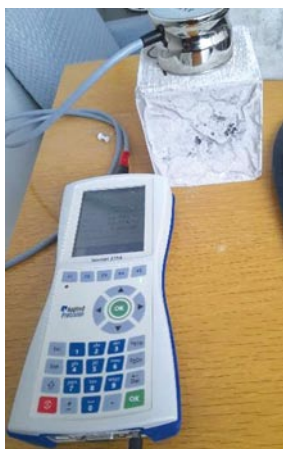
Rys. 1. Aparat ISOMET 2114 podczas wykonywania pomiaru
