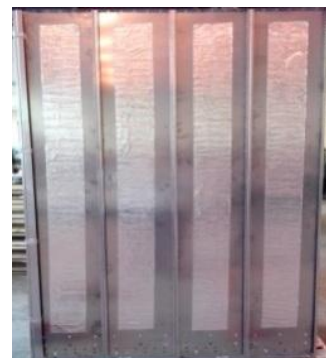
Rys.3. Zewnątrz ściana kabiny dźwigu z widocznymi pasami wygłuszającymi. [7]
