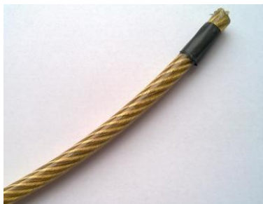
Rys.6. Lina stalowa do dźwigu w oplocie poliamidowym. [opracowanie własne]
