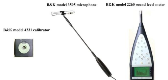
Rys. 2. Urządzenie pomiarowe Bruel Kjaer 2260 z dwumikrofonową sondą i kalibratorem.
