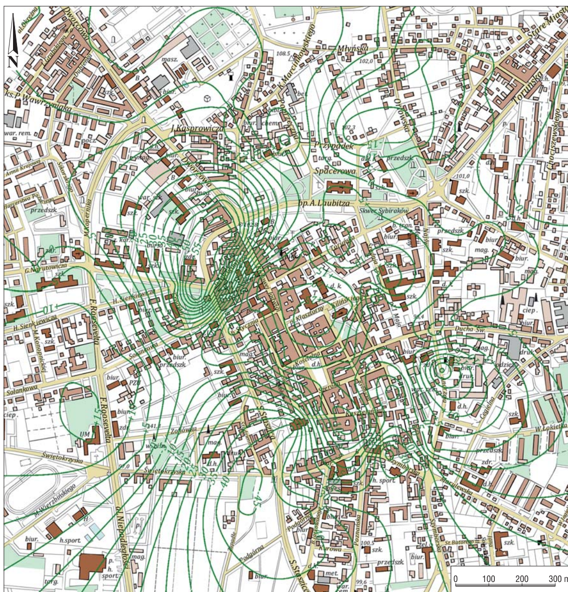
Ryc. 3. Mapa pionowych przemieszczeń powierzchni terenu [mm] zarejestrowanych w latach 1932–1956 w centrum Inowrocławia (na podkładzie mapy topograficznej pozyskanej z portalu geoportal.gov.pl)
