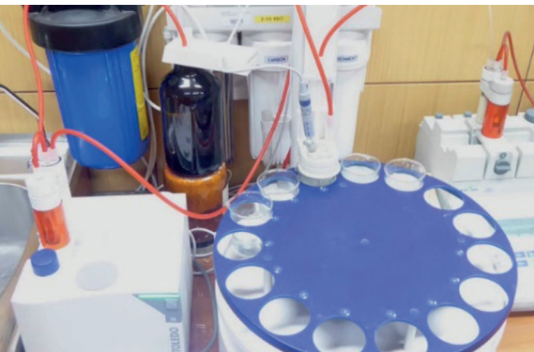
Rys. 3. Potencjometr z automatycznym podajnikiem próbek do analizy stopów srebra firmy Mettler Toledo
