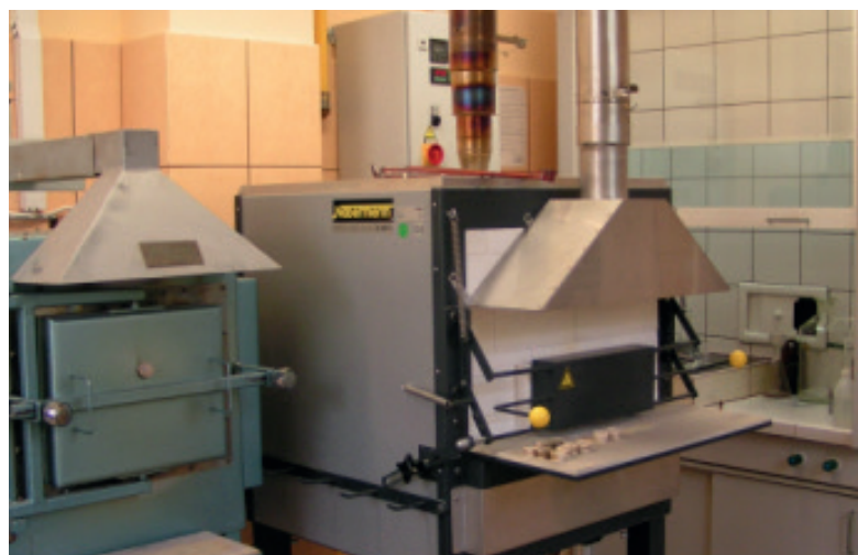
Rys. 2. Piec kupelacyjny do analizy stopów złota (metoda ogniowa)
