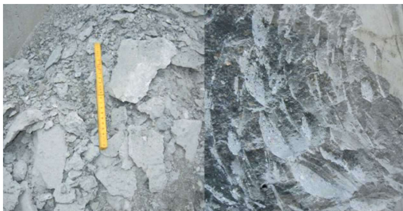
Rys. 5. Widok urobku i powierzchni urabianej próbki uzyskanych podczas prób urabiania głowicą z narzędziami o złożonej trajektorii ruchu [2]
