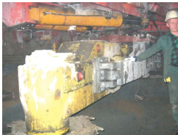
Rys. 16. Widok wysięgnika zawieszenia układu napędu organu urabiającego wraz z głowicą i organem urabiającym w kombajnie szybowym KDS-2 [9]
