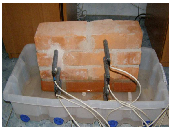
Rys. 2. Ścianka wraz z sondami umieszczona w kuwecie na plastikowych podstawkach
