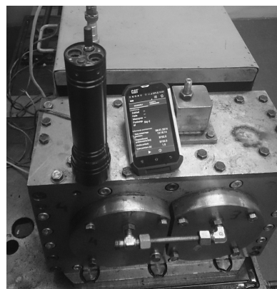
Rys. 1. Stanowisko badawcze, w skład którego wchodzi: badana przekładnia, urządzenie pomiarowe WiViD oraz urządzenie rejestrujące – analizujące (smartfon)
