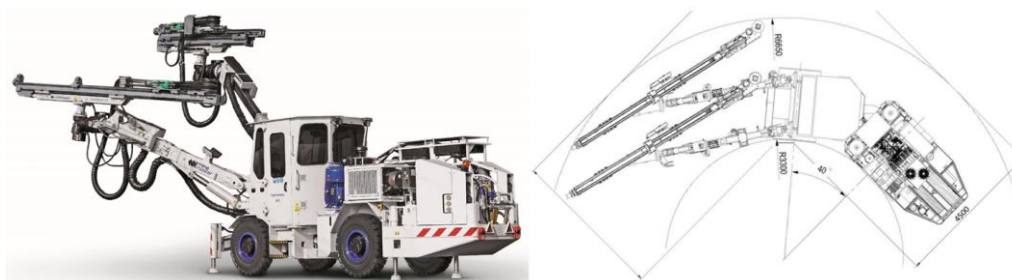
Rys. 2 Przykładowy dwuwysięgnikowy wóz wierzący Face Master 2,3 firmy Mine Master: a. widok maszyny, b. ułożenie podczas pokonywania łuku
