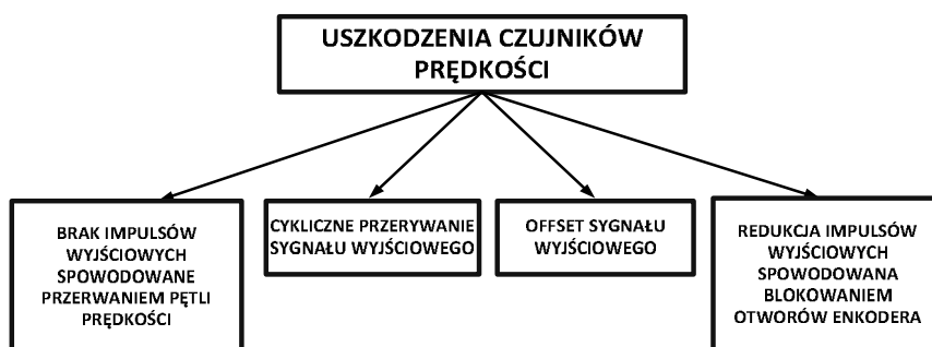
Rys. 5. Rodzaje uszkodzeń czujników prędkości
