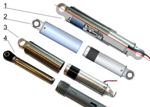
Rys. 9. Konstrukcja tłumika opisanego w pracy: 1 – półprzekrój, 2 – model 3D, 3 – wykonany tłumik elektromechaniczny, 4 – oryginalnie stosowany tłumik cierny o stałym tłumieniu
