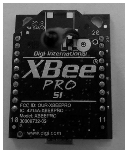
Rys. 3.1. Zastosowany moduł XBee Pro
