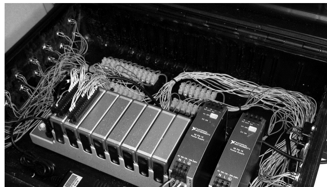
Rys. 7. Jednostka centralna systemu akwizycji danych
